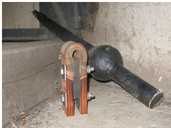
Der abgebrochene Klöppel
